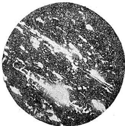
Фиг. 7. Общий вид дюренового гумусово-сапропелевого угля II типа а—водоросли, с—кутикула, д—прослой ксенолитрена. Увел. 55, скв. 4, слой 21/21, верт. разр. тонк. шлиф.
