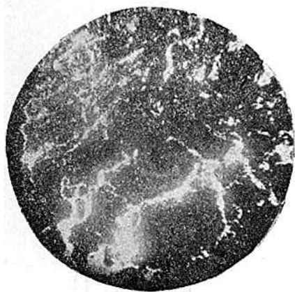
Фиг. 9. Общий вид сажистого угля II типа: т — микроспоры, р — минер. образования. Увеличение 60, скв. 2, слой 21/21, верт. разрез тонкий шлиф.
